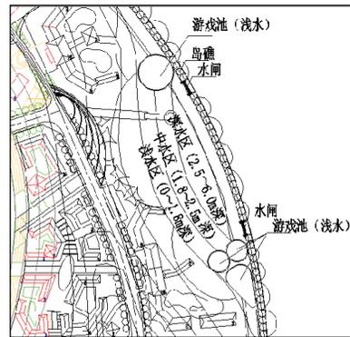
海高水位齐平，水深为 2m，并设置水闸，泳池使用时水闸关闭，与外海隔断，需要补给水时开启；泳池中央区与外海连通，形成浅水、中水和深水之渐变式泳区，其中深水区比外海低潮位低 2m 以上，确保落潮时深水区还具备使用的条件，深水区与外海分界处设置岛礁，减少波浪的侵袭，并形成天然的景观。通过上述平面布置，大部分时间段泳池能满足全天候使用的要求，在台风季、或外海水质不良期，南北封闭的浅水泳区仍能维持使用，浅水和深水区还可通过高低自然排水，形成与外海之间自然的水体交换，大大降低未来的管理运营成本。
